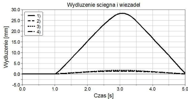
Rys. 6. Wydluzenie ścięgna mięśnia czworogłowego i więzadeł rzepki w funkcji czasu
