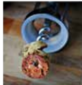
przyczepność większa niż wytrzymałość osnowy
