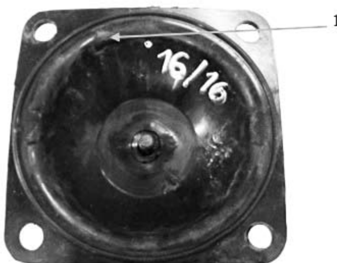
Rys. 18. Membrana po badaniu, na rysunku zaznaczono miejsce rozerwania, 1 – miejsce uszkodzenia [8] Fig. 18. Diaphragm after test, there are visible marks of the wearing and failure, 1 – failure place [8]
