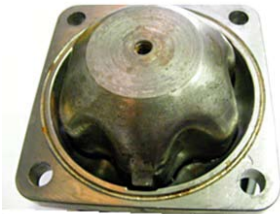
Rys. 15. Konstrukcja grzyba oraz pokrywy zaworu po modyfikacji [7]
