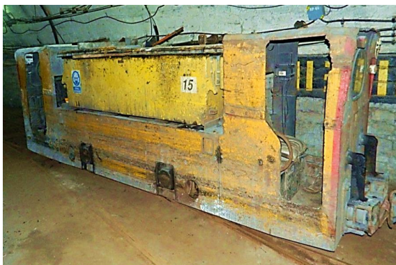
Rys. 2. Górnicza lokomotywa akumulatorowa typu Lea BM-12 napędzana silnikiem szeregowym typu LDs-245 [6,7]
