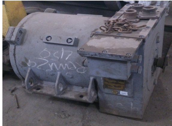
Rys. 3. Górnicza lokomotywa akumulatorowa typu Lea 12P3A napędzana silnikiem szeregowym prądu stałego typu LDs-327 [6,7]
