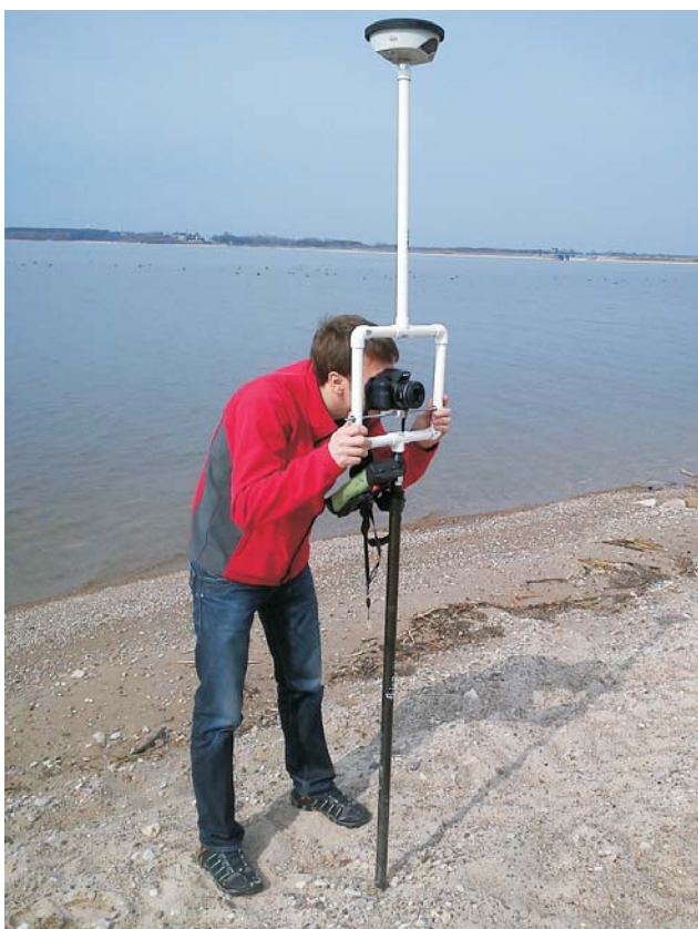
Ryc. 4. Jednoczesne wykonywanie zdjęć i pomiarów GPS z użyciem statywu Fig. 4. Simultaneous capturing of images and GPS measurements using a monopod
