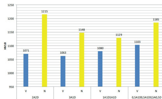
Rysunek 3. Porównanie powierzchniowej twardości HV10 dla stali HS6-5-2 azotowanej przy różnych podziałach procesów na segmenty nasycania (N) i dyfuzji (D). Segmenty dyfuzji prowadzono w próżni (V) bądź w azocie (N)
