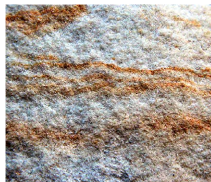
Ryc. 13. Drobnziarnisty piaskowiec kwarcowy o spoiwie ilasto-krzemionkowym, przypuszczalnie z okolic Żelazna
