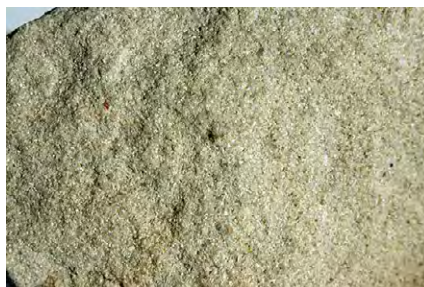
Ryc. 5. Szaro-beżowy piaskowiec kwarcowy o spoiwie ilasto-krzemionkowym z okolic Radkowa
