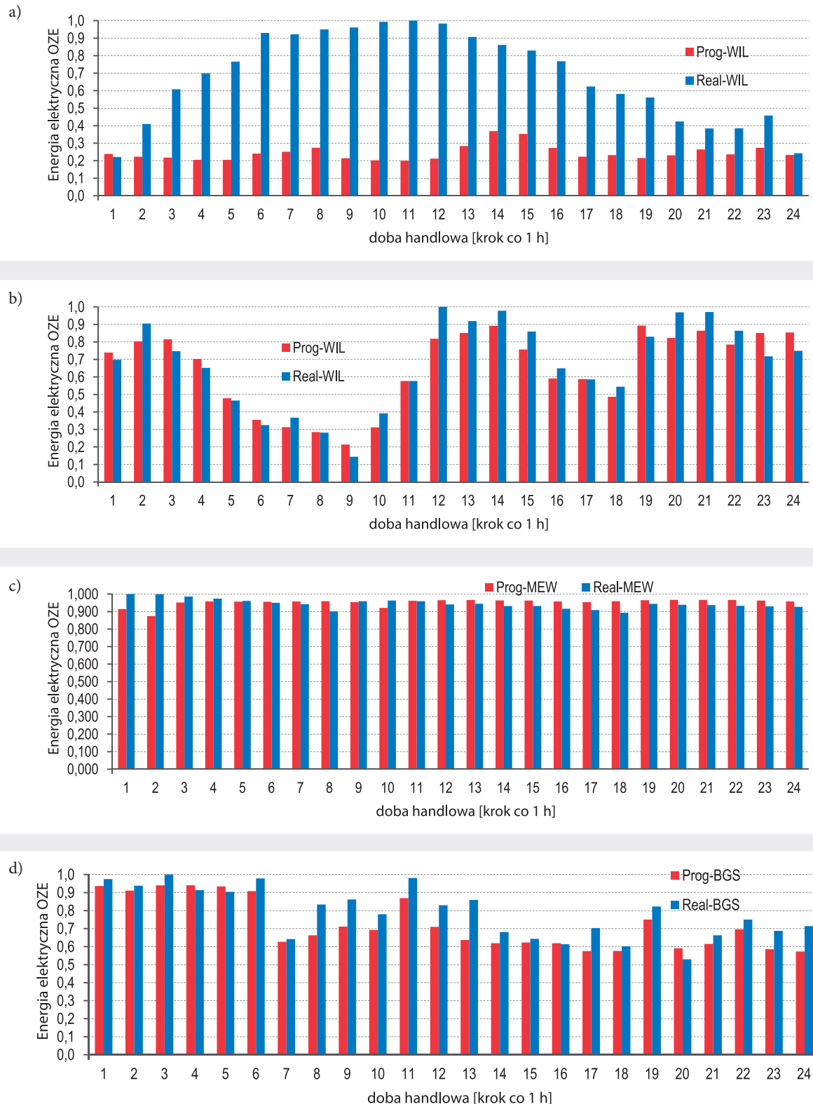
Rys. 3. Dobowo-godzinowa produkcja energii elektrycznej w OZE w ciągu jednej doby handlowej wraz z prognozą: a) i b) elektrowni wiatrowej, c) elektrowni wodnej oraz d) elektrowni biogazowej
