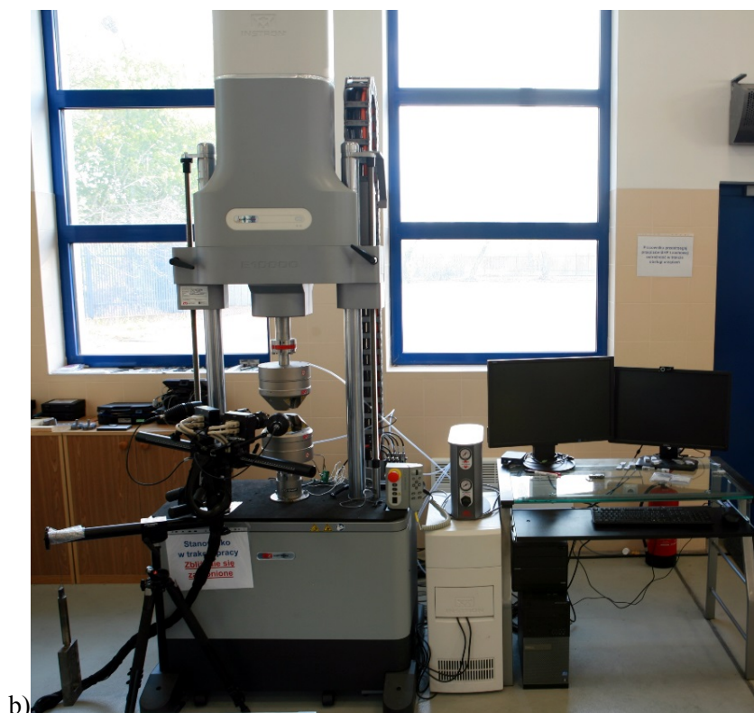
Rys.3. Stanowisko pomiarowe Instron E10000
