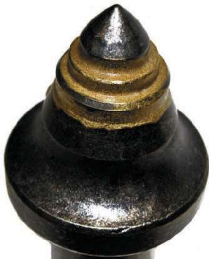
Rys. 4. Nóż stycznno-obrotowy z dodatkowym pierścieniem z węgliku spiekanego Fig. 4. Tangential-rotary pick with the additional ring made of sintered carbide
