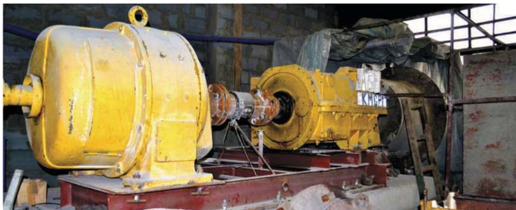
Rys. 7. Stanowisko do badania właściwości noży kombajnowych Fig. 7. Testing stand for the examination of the quality of cutting picks
