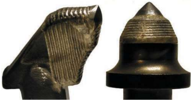
Rys. 3. Nóż promieniowy i nóż stycznno-obrotowy ze wzmocnionymi korpusami metodą napawania Fig. 3. Radial pick and tangential-rotary pick with strengthened bodies by the use of cladding
