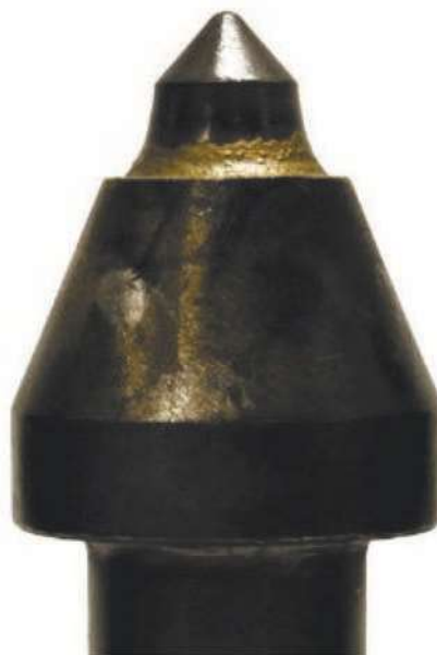
Rys. 5. Nóż stycznno-obrotowy z obniżonym korpusem i z węglikiem spiekany typu CAP Fig. 5. Rotary-tangential pick with lowered body and sintered carbide of the type CAP
