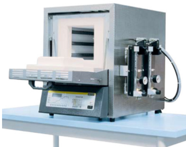
Rys. 7. Prasę izostatyczną (a) oraz piec komorowy Nabertherm HTC 03/16 znajdujące się na wyposażeniu Laboratorium Mikrosystemów Grubowarstwowych Wydziału Elektroniki Mikrosystemów i Fotoniki Politechniki Wrocławskiej [12]
