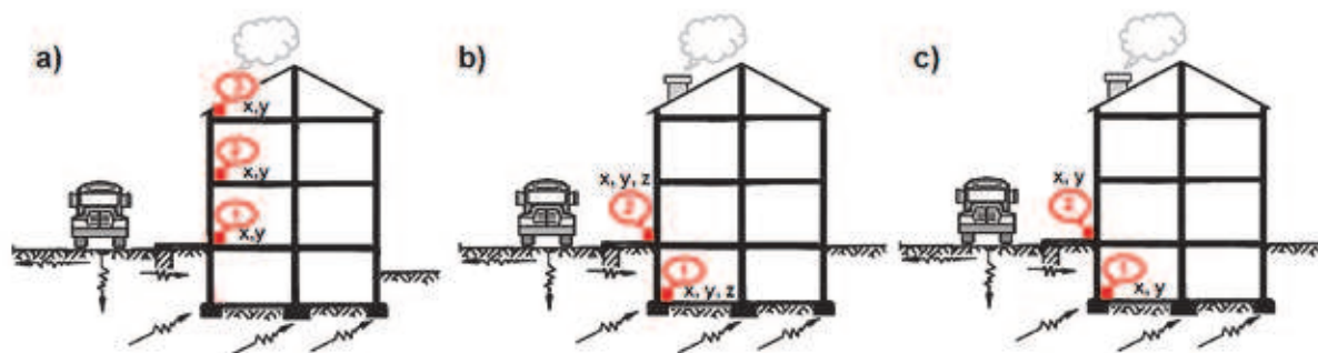
Rys. 5. Zasady rozmieszczenia punktów pomiarowych i składowe mierzonych drgań ( x, y, z ): a) przy wyznaczaniu poziomych sił bezwładności na poszczególnych kondygnacjach na podstawie pomiaru przyspieszeń, b) przy wyznaczaniu parametrów wymuszenia kinematycznego na istniejącym budynku, c) przy stosowaniu skal SWD do oceny wpływu drgań na konstrukcję budynku
