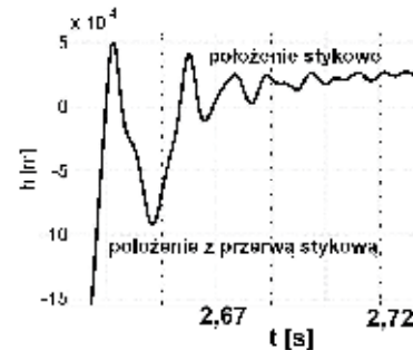
Rys. 3. Ruch nakładki pantografu w trakcie przerwy stykowych
