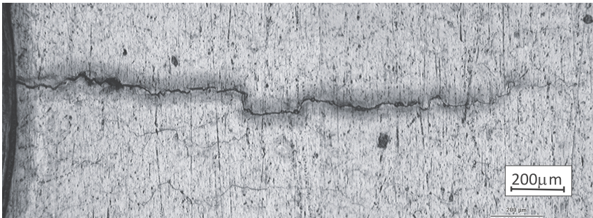
Rys. 5. Obraz pęknięcia na powierzchni próbki z otworem wierconym i rozwierczanym zarejestrowany za pomocą repliki po N_i = 380\,000 cykli obciążenia ( \sigma_a = 103 MPa, N_f = 639\,600 cykli)
