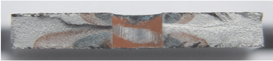
Rys. 4. Przełom platerowanej próbki z walcowym otworem poddanej badaniu przy amplitudzie naprężenia zginającego \sigma_a = 103 MPa ( N_f = 507\,400 cykli)
