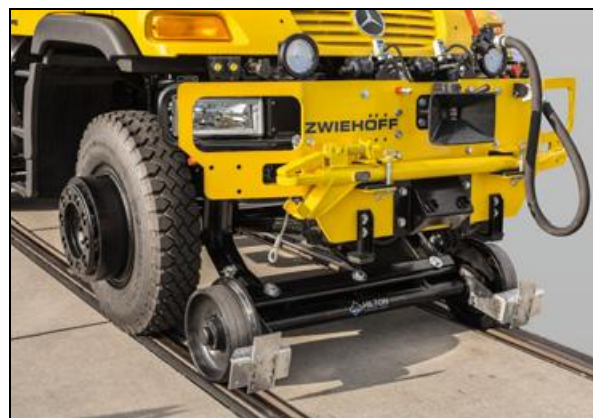
Rys. 6. Fragment układu hydraulicznego zastosowanego w samochodzie U423 [12]
