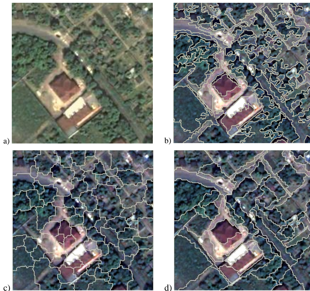
Rys. 1. Fragment terenu poddany różnym próbom segmentacji (a) oraz kolejne wyniki: b) jedynie kryterium barwy (K – 100%), c) 90% udział czynnika zwartości (Z) oraz 10% barwy (K), c) 90% udział czynnika rozciągłości (R) oraz 10% barwy (K),
