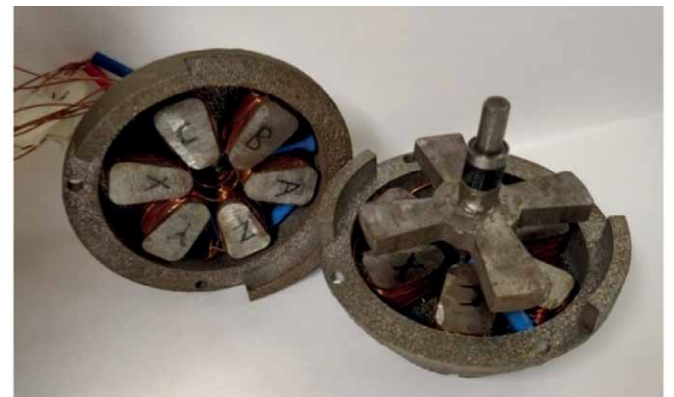
Rys. 4. Silnik reluktancyjny wydrukowany w technologii SLM [9]
