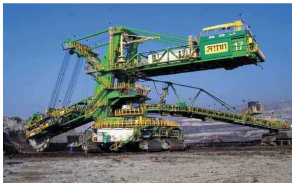
Rys. 6. Koparka KWK 910 do utworów trudno urabialnych w PGE GiEK S.A. Oddział KWB Turów [Fot. SKW Zgorzelec]
