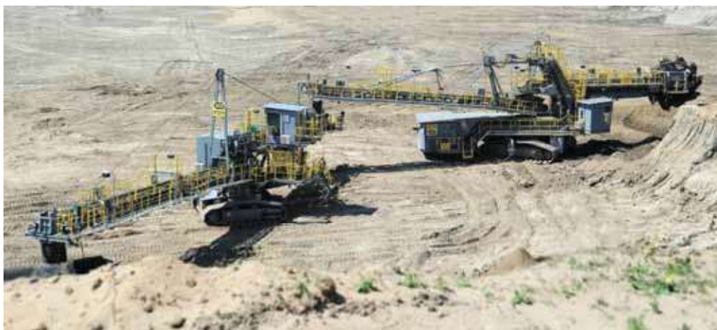
Rys. 7. Koparka kompaktowa KWK-250 wraz z przenośnikiem PGOT-1250.38 w PAK KWB Konin S.A. [Fot. P. Ordan]
