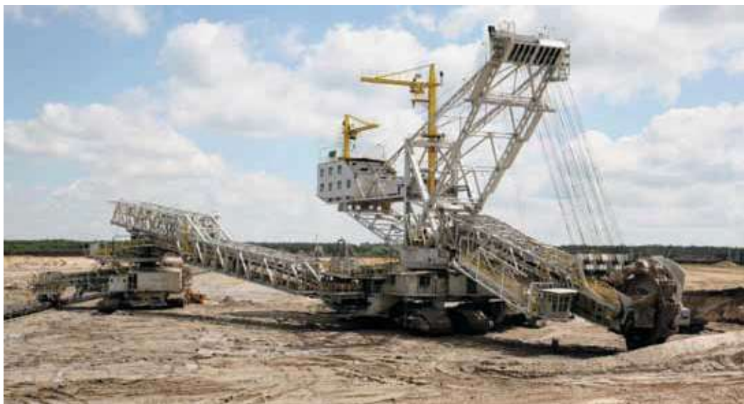
Rys. 3. Koparka kołowa KWK 1500s na odkrywce Tomislawice PAK KWB Konin S.A. [Fot. P. Ordan]
