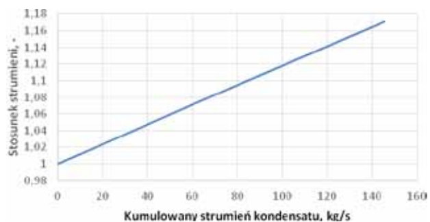
Rys. 10. Stosunek strumienia pary płynącej przez ostatnią grupę stopni części niskoprężnej do strumienia płynącego przez tę część w warunkach nominalnych
