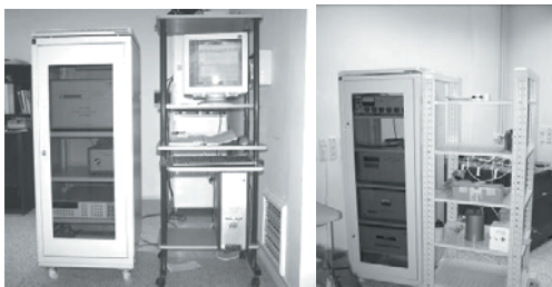
Rys. 7. Stanowiska pomiarowe oparte o komparatory rezystancji Fig. 7. Measurement systems using resistance comparators
