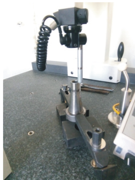
Rys. 7. Pomiar stożka sondą elektrostatyczną na WMP VISTA ZEISS metodą digitalizacji
