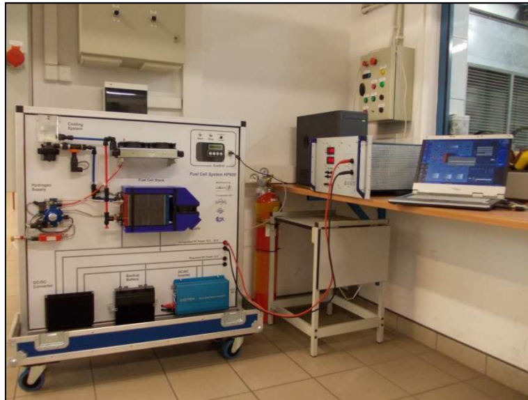
Rys. 4. Dydaktyczne stanowisko laboratoryjne z systemem ogni paliwowych firmy Heliocentris
