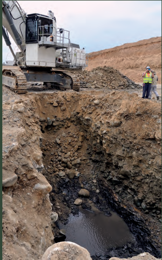
Ryc. 11. Odkrywkowa eksploatacja rozsypanych złóż diamentów w rejonie pomiędzy Kimberley a Douglas w RPA. Fot. A. Kozłowska
