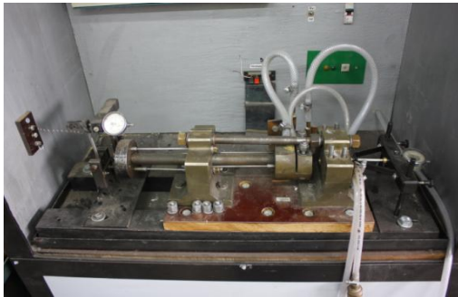
Rys. 1. Stanowisko do badania zmęczenia cieplnego
