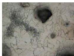
Rys. 8. Mikrostruktura żeliwa ADI w próbce w strefie nagrzewania do 700°C
