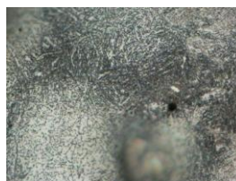
Rys. 7. Mikrostruktura żeliwa ADI w próbce w strefie nagrzewania do 600 - 650°C
