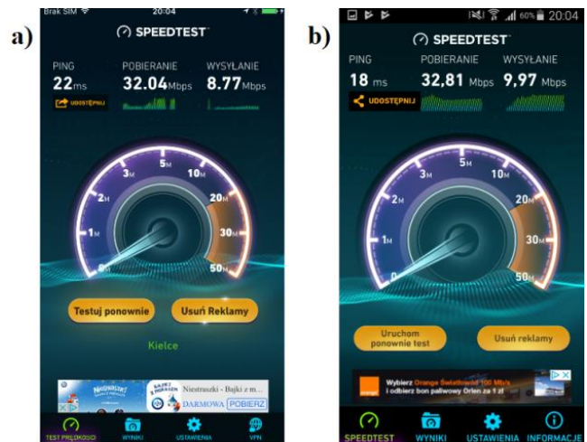
Rys. 8. Test łącza WiFi: a) iPhone 6s b) Samsung S4 [opracowanie własne autorów]
