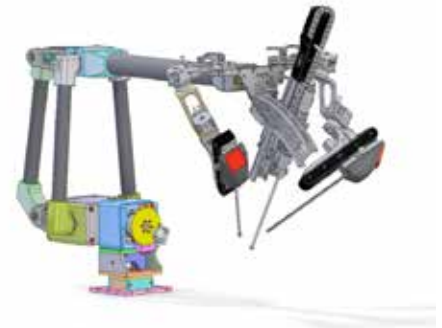
Rysunek 2. Model telemanipulatora Robin Heart Tele
