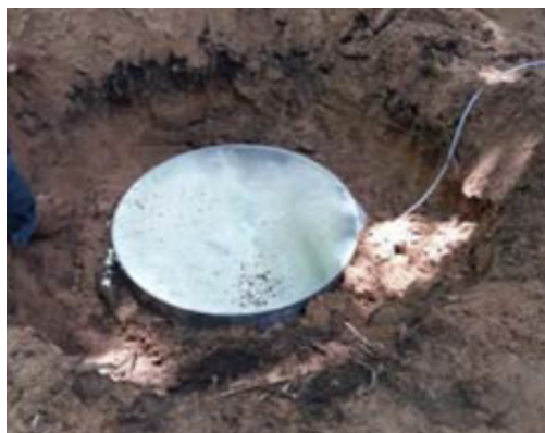
Rys. 5. Moduł pomiaru drgań wykorzystany w badaniu w Tajlandii [29]
