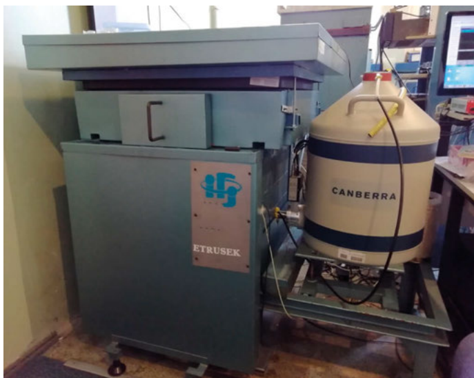
Fot. 1 Widok ogólny spektrometru promieniowania gamma w IFJ PAN Źródło: własne.
