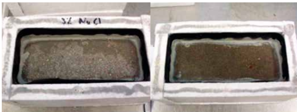
Rys. 6. Próbkę po badaniu mrozoodporności (z lewej CEM I 42,5 R odladzana 3% NaCl, z prawej CEM I 42,5 R odladzana 30% mocznikiem)
