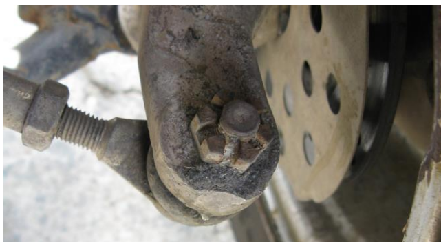
Rys. 2. Przykład nieprawidłowego montażu elementów – brak wymaganego zabezpieczenia połączenia gwintowego
