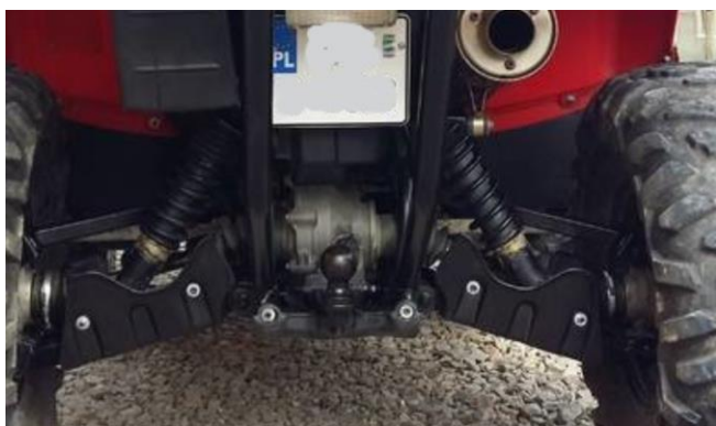
Rys. 7. Napęd pojazdu czterokołowego z mechanizmem różnicowym i zawieszeniem niezależnym
