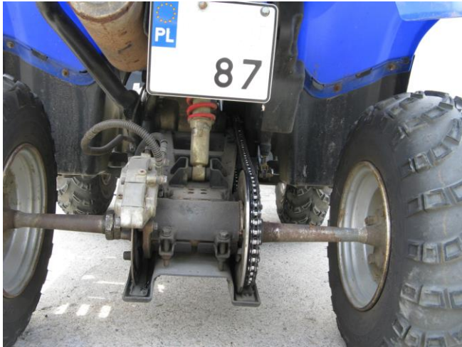
Rys. 6. Napęd łańcuchowy pojazdu czterokołowego z dzieloną osią zespoloną
