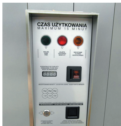
Fot. 4. Elektroniczny wrzutnik monet i panel obsługowy – źródło: Zarząd Transportu Miejskiego w Lublinie
