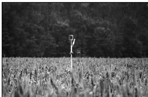
Rys. 1. System pomiarowy zainstalowany 1,5 metra nad powierzchnią łanu kukurydzy
