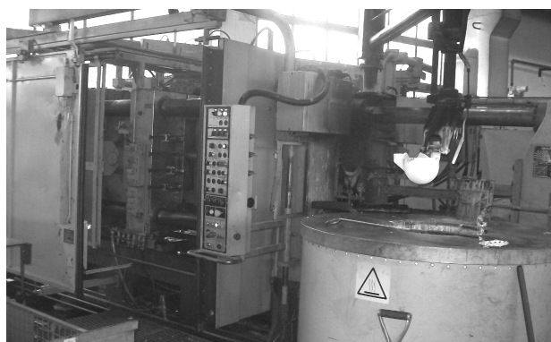
Rys. 1. Ciśnieniowa maszyna odlewnicza firmy BÜHLER, typ H630-B wraz z piecem podgrzewczym oraz urządzeniem do zalewania ciekłego stopu
