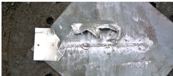
Rys. 16. Widok prawidłowego zadziałania inicjatora detonacji, w tym przypadku dla masy ładunku słonkowego 80 mg
