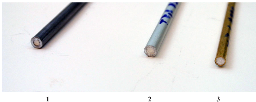
Rys. 10. Widok lontów detonujących w powłoce metalowej: 1 – lont detonujący typu LD-PETN5F, wyciągany w powłoce Pb/Sb; 2 – lont detonujący w otoczce aluminiowej o średnicy 5 mm, rdzeń MW o średnicy 3 mm; 3 – lont detonujący w rurce z mosiądzu o średnicy 4 mm, rdzeń MW o średnicy 3 mm
