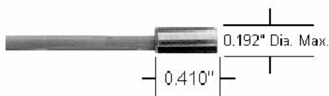
Rys. 5. Wymiary mikrodetonatora RP-87 [3]: średnica ok. 4,9 mm, długość ok. 10,4 mm
