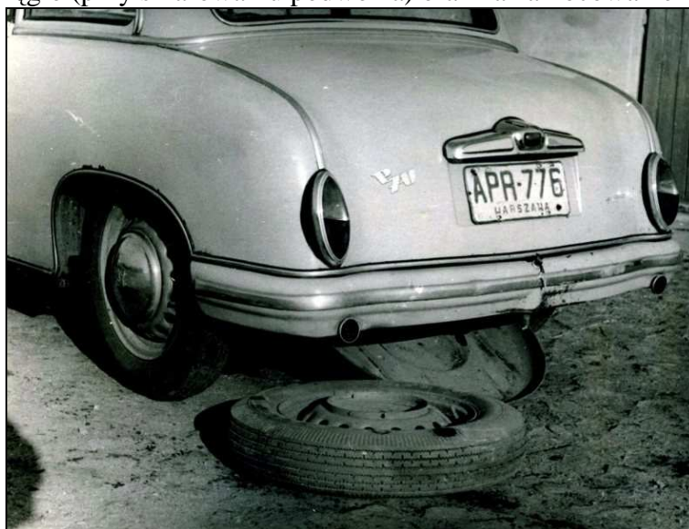
Fot. 8. Mocowanie koła zapasowego w samochodzie P-70 [4]
