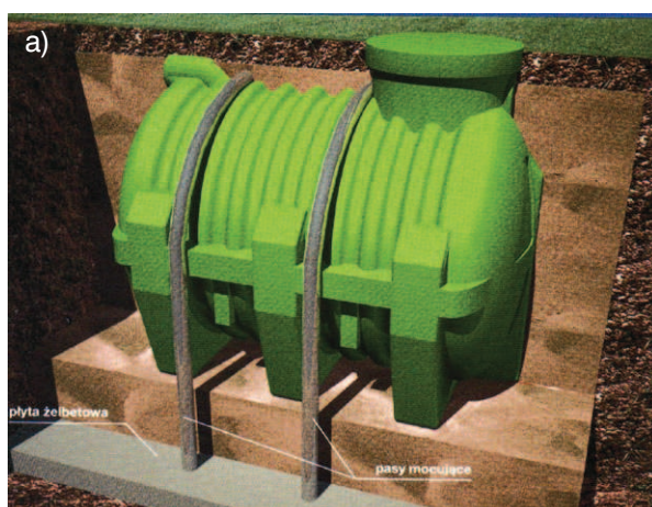
Rys. 6. Osadniki gnilne podziemne [4]: a) posadowienie, b), c) schemat w rzucie głównym i z boku wraz z wymiarami – osadnik gnilny o pojemności 2000 litrów – b) i o pojemności 3000 litrów c)
