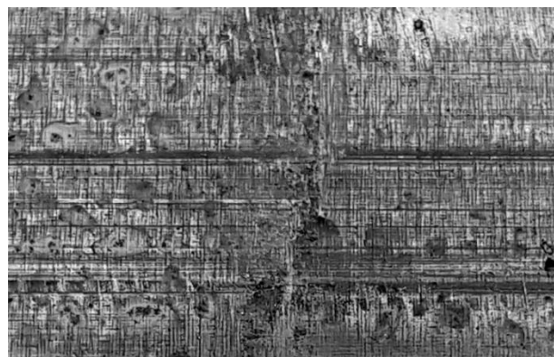
Rys. 2. Uszkodzenia powierzchni osi – wżery
