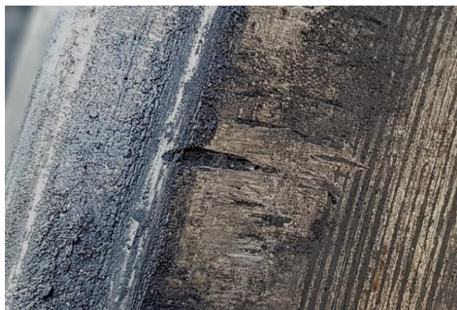
Rys. 6. Uszkodzenia powierzchni tocznej koła w postaci wyrwania materiału
