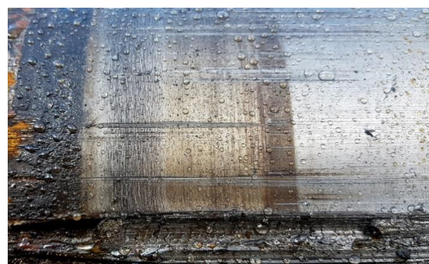
Rys. 3. Uszkodzenia powierzchni osi – rysy, bruzdy
