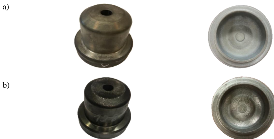
Rys. 3. Analizowany wypełniacz wkładki górnej: a) nowy – przed pracą wraz z odkuwką z początku pracy, b) zużyty – po odkuciu 12 500 odkuwek wraz odkuwką z końca eksploatacji narzędzia
