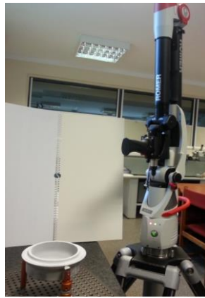
Rys. 4. Stanowisko pomiarowe do badań laboratoryjnych odkuwek z ramieniem pomiarowym ROMER Absolute ARM 7520si wyposażonym w zintegrowany skaner laserowy
