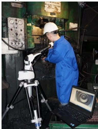
Rys. 1. Widok prasy wraz z zabudowanymi narzędziami kuźniczymi do kucia pokrywy oraz dokonywany bezpośrednio na produkcji pomiar skanowaniem wypełniacza z wykorzystaniem ramienia pomiarowego
