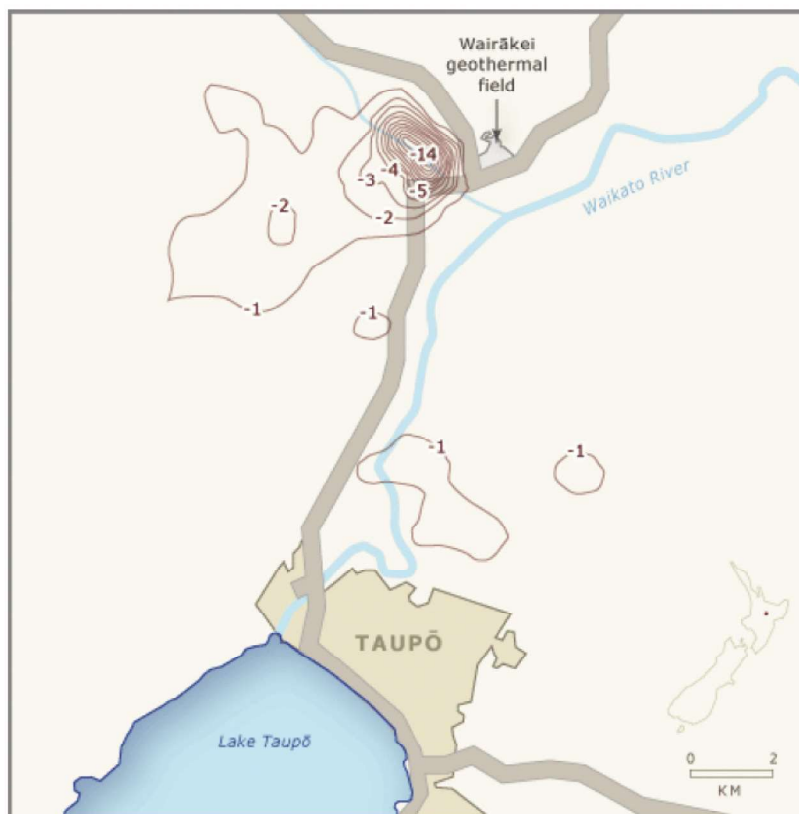
Rys. 4. Obniżenia wyrażone w [m] w rejonie pól geotermalnych zlokalizowanych w Nowej Zelandii na przestrzeni 50 lat (Stewart 2006)
