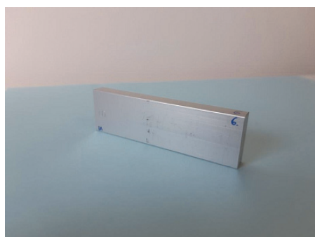
Rys. 6. Próbką numer 6 po procesie anodowania (fot. A. Piochacz) Fig. 6. Sample no. 6 after anodizing (photo by A. Piochacz)
