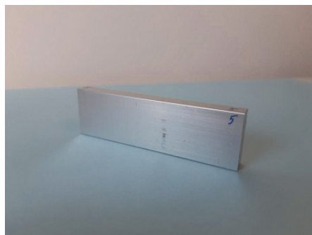
Rys. 5. Próbką numer 5 po procesie anodowania (fot. A. Piochacz) Fig. 5. Sample no. 5 after anodizing (photo by A. Piochacz)
