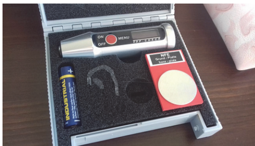
Rys. 1. Tester TOP CHECK do pomiaru grubości warstw anodowanych (fot. A. Piochacz)
