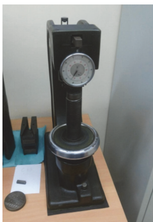
Rys. 2. Twardościomierz firmy Łucznicz (fot. A. Piochacz)
