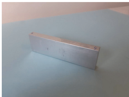
Rys. 4. Próbka numer 4 po procesie anodowania (fot. A. Piochacz)
