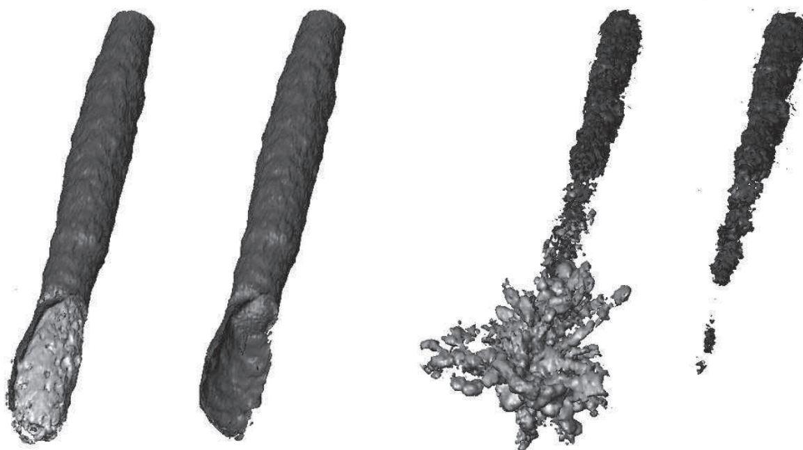
Rys. 3. Obrazy tomograficzne kanału perforacyjnego uzyskanego w symulowanych warunkach otworowych uwidaczniające resztki z wkładki kumulacyjnej w skale piaskowcowej (lewa strona) i wapiennej (prawa strona) [1]
