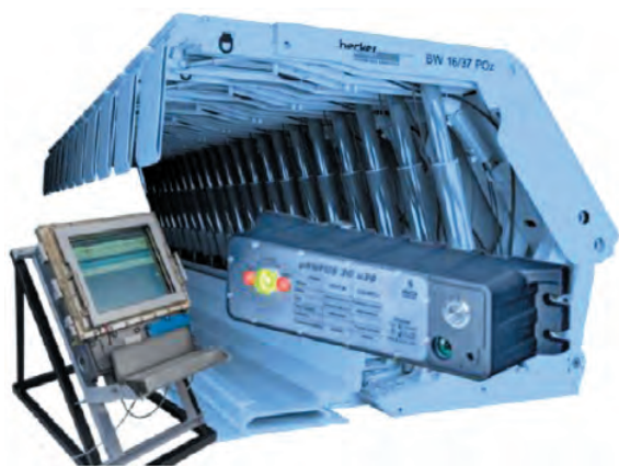
Rys. 6. Układ aktywnego podtrzymania ciśnienia firmy Elsta [22]
