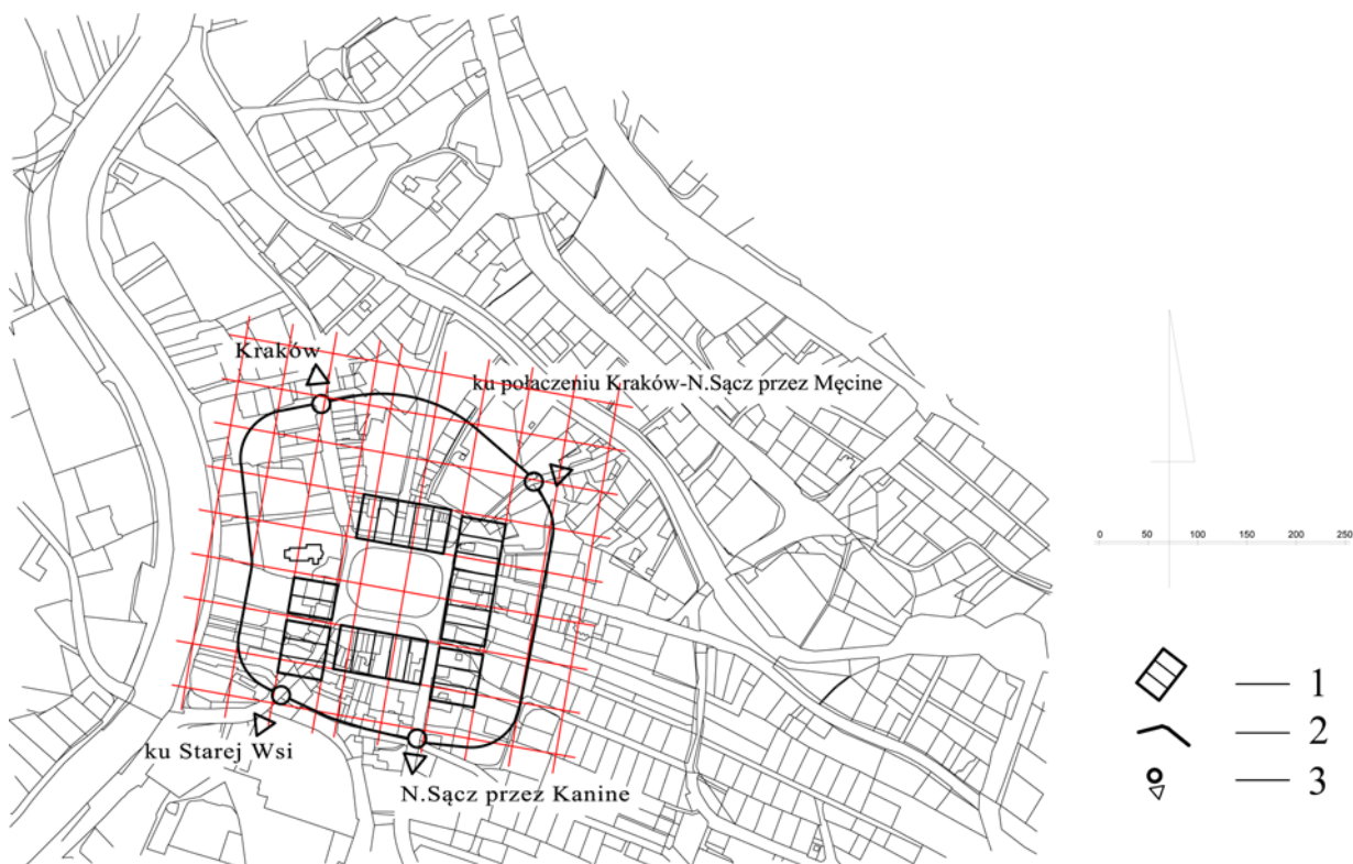
Ryc. 8. Limanowa. Próba rekonstrukcji zasad rozplanowania układu lokacyjnego miasta w oparciu o wielkość działki siedliskowej na tle modularnej siatki mierniczej o wielkości 1 sznura liczonego stopą o długości 0,3 metra. Opracowanie autora na bazie współczesnej cyfrowej mapy ewidencji gruntów
