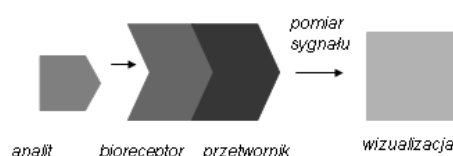
Rys. 1. Schemat działania biosensora Fig. 1. Diagram of biosensor activities
