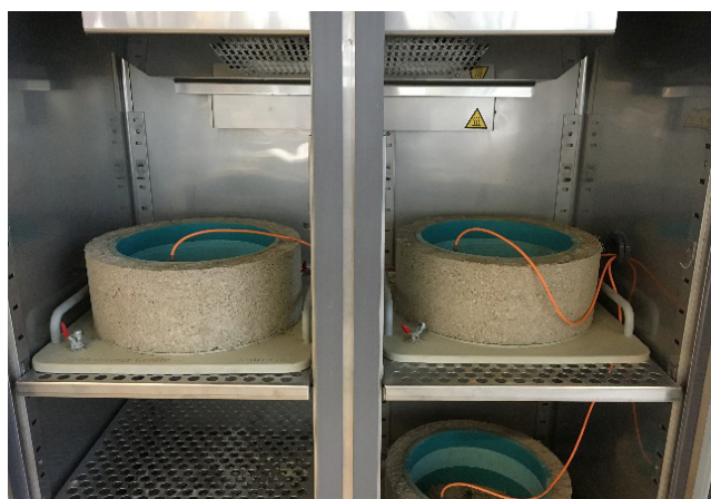
Rysunek 6 Próbkę przechowywane w komorze klimatycznej w czasie badania
