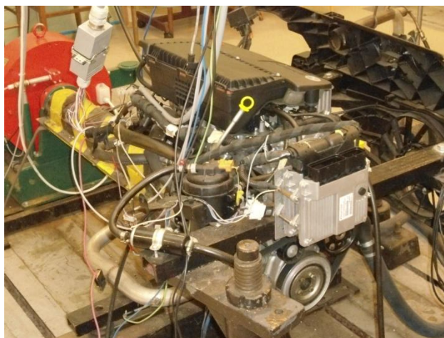
Rys. 1. Obiekt badań - silnik 1.3 JTD MultiJet
