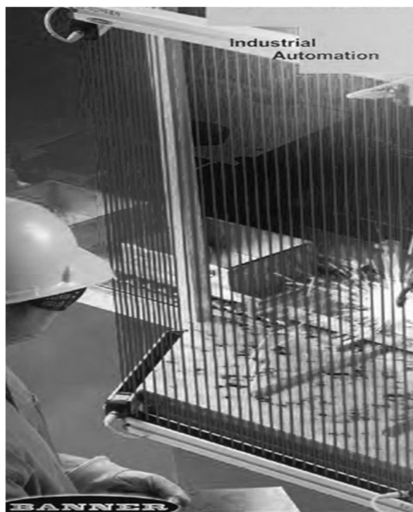
Rys. 3.4 Kurtyna świetlna włączona podczas procesu spawania
