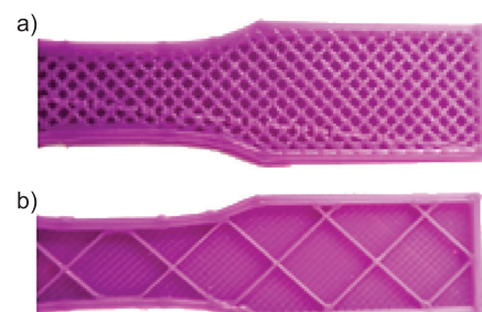
Rys. 4. Przekrój poprzeczny próbek z polilaktydu do próby rozciągania: a) z gęstością druku 50%, b) z gęstością druku 10%
