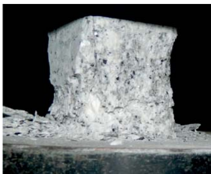
Fot. 10. Widok próbki po badaniu wytrzymałości na ściskanie (surowiec polski); fot. – źródło własne
