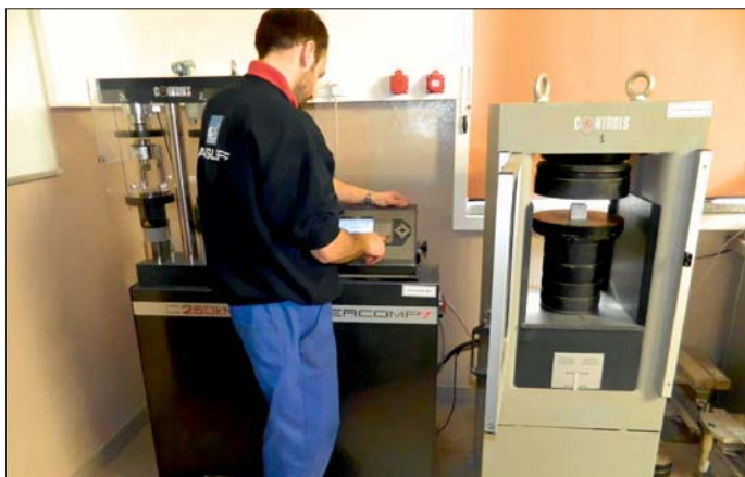
Fot. 7. Stanowisko do badania wytrzymałości na ściskanie próbek; fot. – źródło własne
