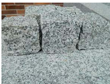
Fot. 1. Granit pochodzenia polskiego (strzegomski); fot. – źródło własne
