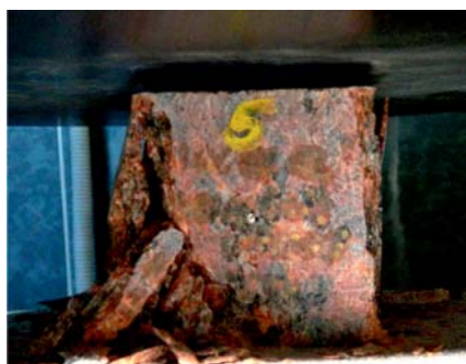
Fot. 9. Widok próbki po badaniu wytrzymałości na ściskanie (surowiec szwedzki); fot. – źródło własne
