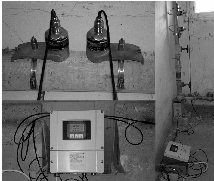
Rysunek 2 Przenośny przepływomierz ultradźwiękowy do tymczasowych pomiarów przepływu cieczy z zewnątrz rurociągu Proline Prosonic Flow 93T
